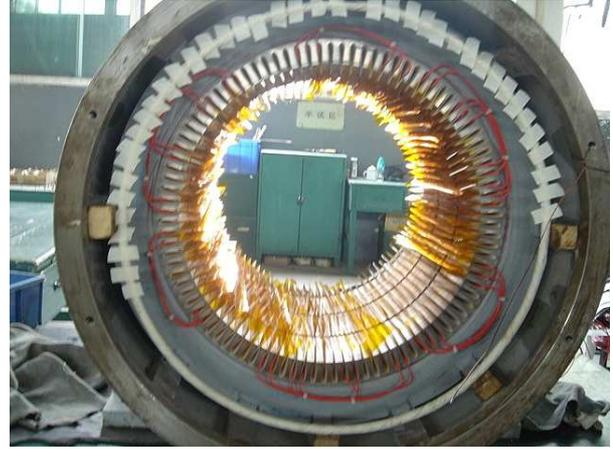
主繞組依發電機端電壓需求可為 $\Delta$ 或 Y 接法， $\Delta$ 接線可能產生內部環流且中性線電抗不平衡，一般均採用 Y 接線。
